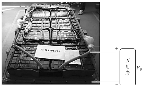
图 1-25 测量电池包高压 V_{正} 对壳体电压
