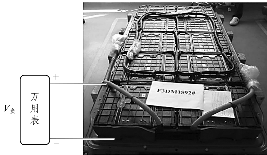
图 1-26 测量电池包高压 V_{负} 对壳体电压
