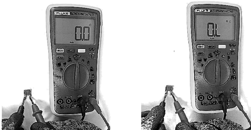
图 1-8 测量熔断器电阻
